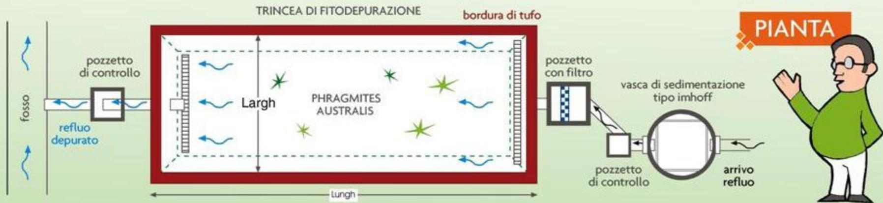
**NB Il pozzetto con filtro non è necessario se la vasca di sedimentazione è stata ben dimensionata !**
